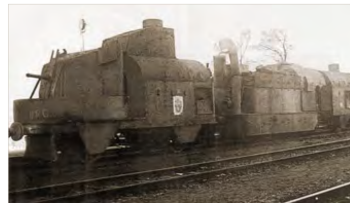
Pociąg pancerny „Piłsudczyk”, po lewej wagon artyleryjski z szybkostrzelną, półautomatyczną armatą morską 7 cm L/30 Škoda. The “Piłsudczyk” armoured train, on the left – the artillery car with quick-firing, half-automatic 7 cm L/30 Škoda naval gun.
