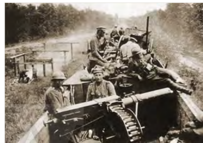
Improwizowany pociąg pancerny „Zagończyk” z drewniano-betonowym „opancerzeniem” wzmocnionym blachą kotłową (parowóz). “Zagończyk” improvised armoured train with wooden-concrete “armour” reinforced with cauldron sheet metal (steam engine).
