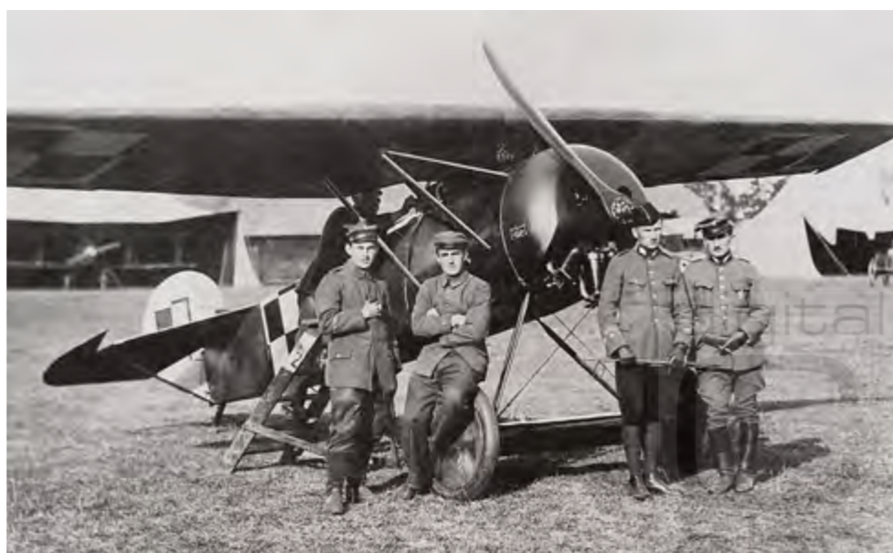
Piloci 12 Eskadry Wywiadowczej i samolot Fokker D VII, lotnisko Kisielewicze pod Bobrujskiem, wrzesień 1919 roku. Moc silnika: 185 KM; prędkość maksymalna: 187 km/h; pułap: 6400 m; zasięg: 400 km.
