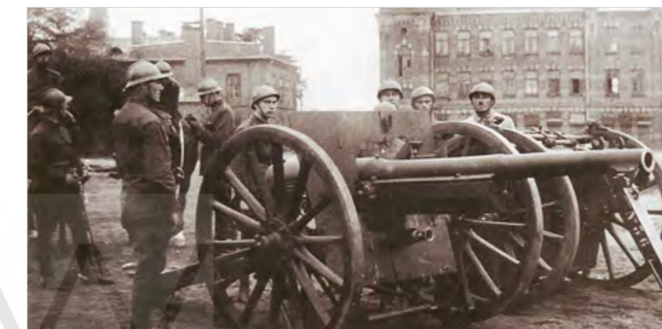
Armaty 75 mm wz. 1897. Kaliber: 75 mm; donośność: 11 200 m; szybkostrzelność: 12 strz. / min. 75 mm mod. 1897 gun. Calibre: 75 mm; weapon range: 11,200 m; rate of fire: 12 rounds / min.
