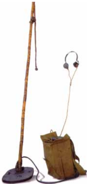
Fot. 3. Wykrywacz min Mine Detector (Polish) Mark 1 z 1941 roku opracowany przez Józefa Kosackiego
