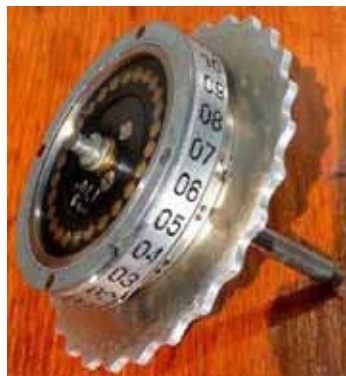
Fot. 3-4. Walec odwracający i wirnik z widocznymi stykami
