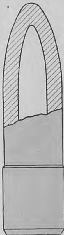
N°83 b Amunicja ślepa. Pocisk drewniany do km. syst. Browninga wz.30 i Maxima wz.08.
