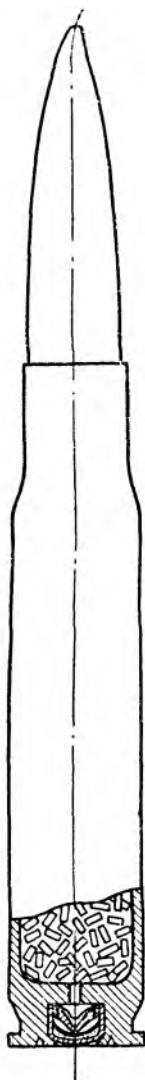
Nº54. Nabój do n.k.m. Hotchkiss'a kal.13,2mm.
