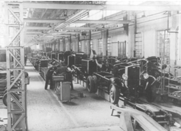
Montaż podwozi ciężarowych Polski Fiat 621L 2,5 t.
