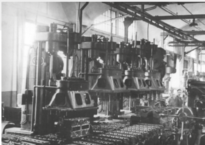
Obróbka bloków silnikowych typu Fiat 122B do ciężarówek Polski Fiat 621.
